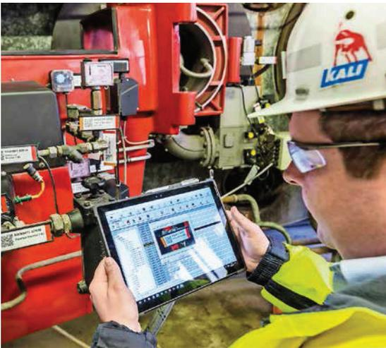
**Dokumentation auf dem Tablet:** Die KKS-Markierung funktioniert auch per QR-Code. Foto: Phoenix Contact
