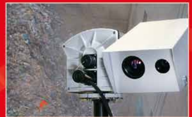
Bunkerinstallation mit Schwenk-Neigekopf
